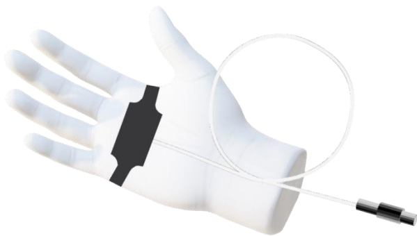
1a 振动传感器固定在作业工人手部
